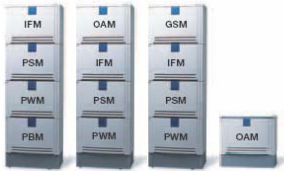
Przykład realizacji konfiguracji 3 x LIM systemu MD110.
